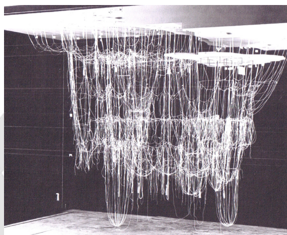
Reconstruction du modèle funiculaire, église Güell, A. Gaudí arch.
